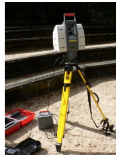
Urządzenie geodezyjne LIDAR – pomiar czasu przelotu
