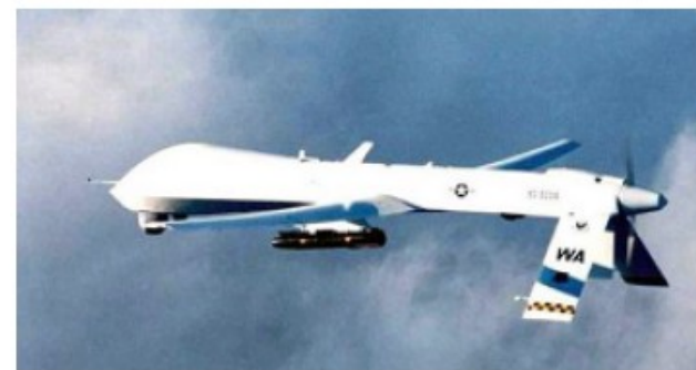
Samolot bezzałogowy wyposażony w rakietę naprowadzaną laserowo Predator US Airforce
