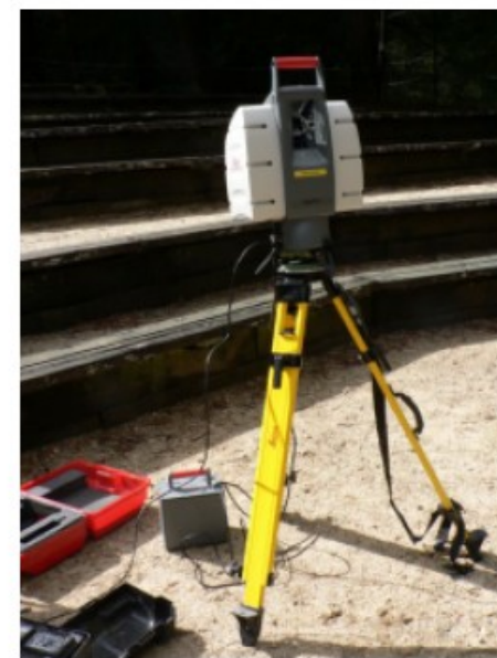
Urządzenie geodezyjne LIDAR – pomiar czasu przelotu
